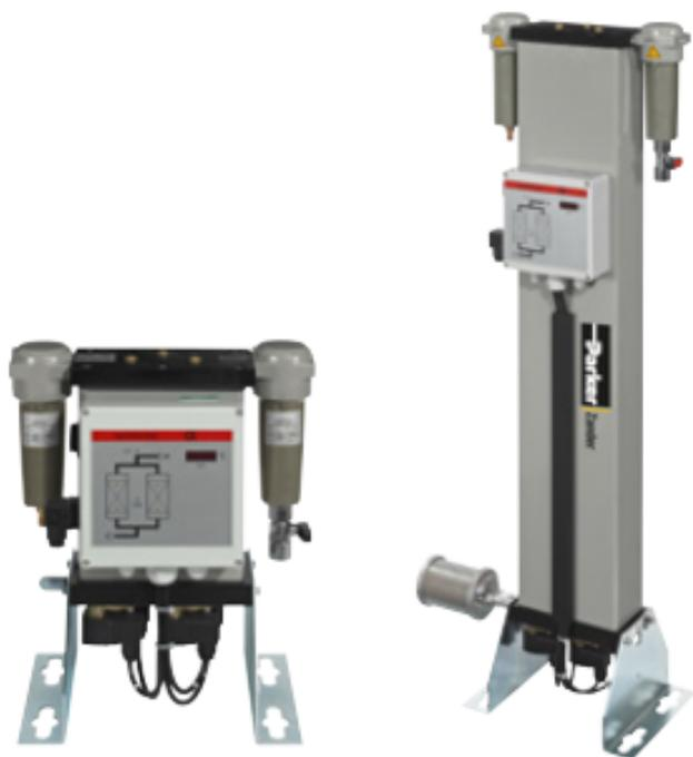
A linha Parker Zander K-MT 1-4 de secadores por adsorção sem aquecimento é projetada para secar o ar comprimido industrial de forma confiável e energeticamente eficiente, podem ser dimensionados para operar com pontos de orvalho pressurizado de -20, -40 ou -70°C.
